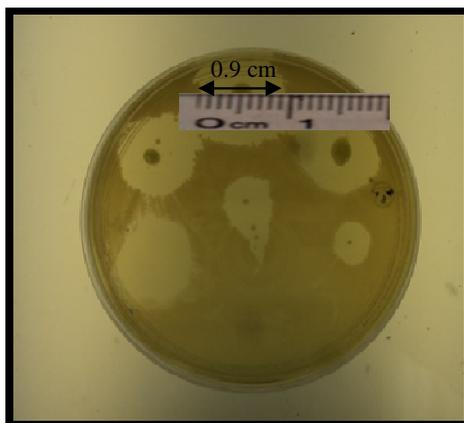
Figura 7. Esquema para cuantificar el diámetro de la inhibición del crecimiento bacteriano por efecto de los extractos de diferentes especies de *Tagetes* en medio sólido *in vitro*.
