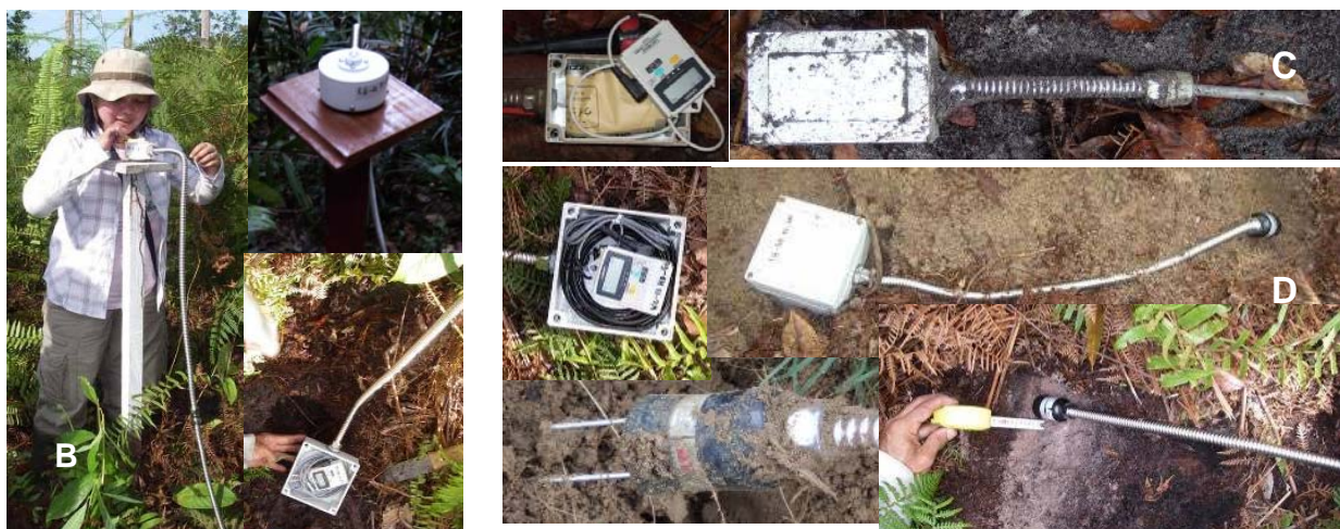
図5-5. 微環境計測システム. A: 大気温湿度, B: 光量子束密度, C: 土壌温度, D: 土壌水分.
