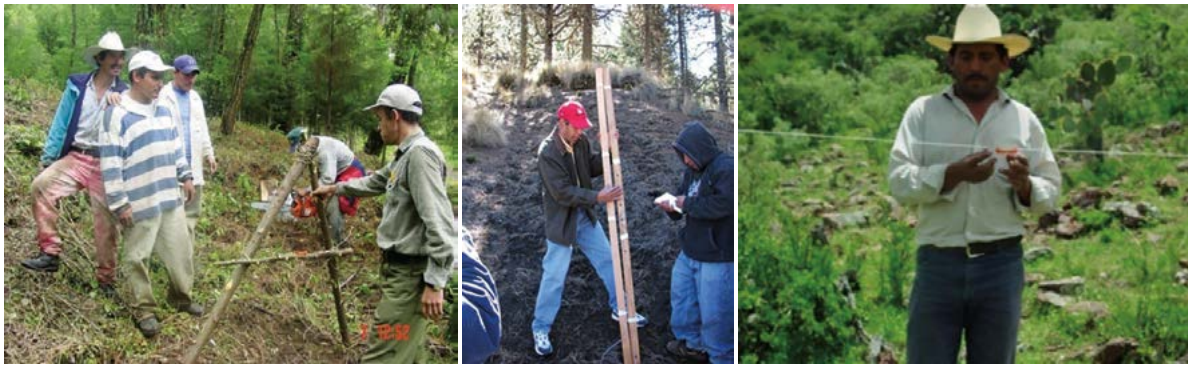
Figura 6. Aparato A (triángulo chino), nivel de manguera e hilo para trazar curvas a nivel.
