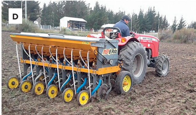
Imagen 4 (continuación). Máquinas cosechadoras de gramíneas nativas (C) y de labranza mínima (D).
