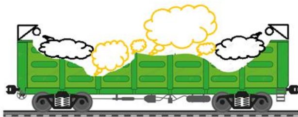
1-расм. Автоматик-автоном (Тунгус, Гранит, Elide fire) ёнғин ўчириш жиҳозини ярим очик вагонга ўрнатиш схемаси
