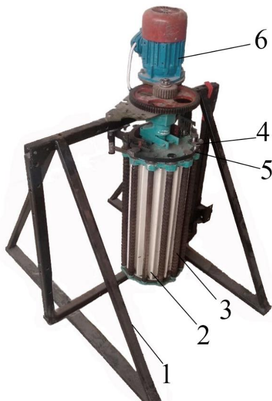
3-rasm. Laboratoriya stendining umumiy ko'rinishi:1-rama; 2-shpindelli baraban; 3-shpindel; 4-prototip g'altak; 5-ko'p qirrali tasma; 6-elektromotor.
