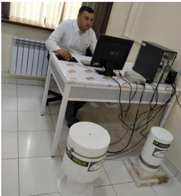
1-rasm. Ssintillyatsion gamma-spektrometr (RADEK) qurilmasi yordamida lishayniklar tarkibidagi radionuklidlar tarkibini aniqlash
