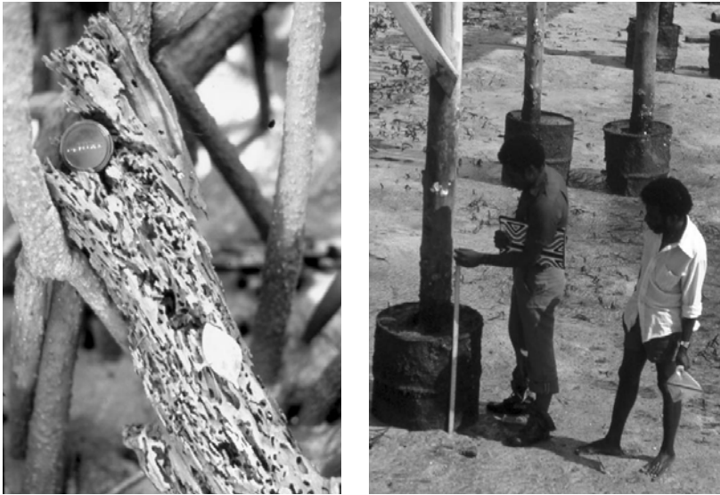
Gambar 4.2.2. Sepotong kayu yang dipenuhi lubang yang dihuni Teredinidae di antara perakaran Rhizophora (kiri) dan Tiang pancang kayu yang dilindungi beton di zona pasang-surut rendah, Port Moresby (kanan).
