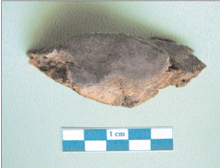
Figura 22.- Muestra CE-MP-3. Sílex gris negruzco masivo y tosco, incluido en caliza crema muy porosa. Serie del Col de Souk El Tleta. Unidades de la dorsal externa.
