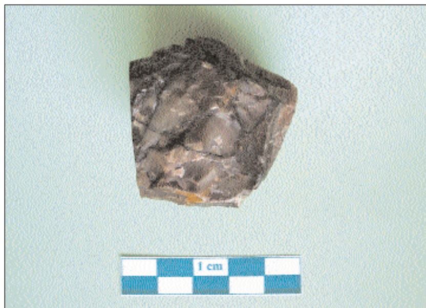
Figura 19.- Muestra CE-MP-1 B. Radiolarita o sílex rosáceo - gris verdoso, del Grupo del Yebel Musa.
