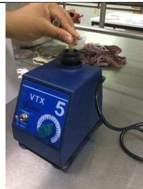
Figura 14 Mezcla de soluciones de extracto
