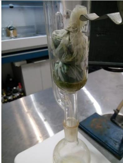
*Figura 3 Cartuchos en la cámara principal del soxhlet*
