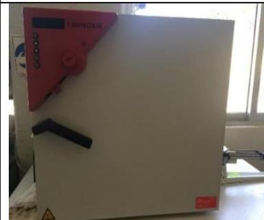
Figura 18 Incubación de placas invertidas a 36°C de 5-7 días.
