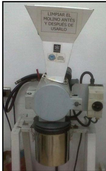
**Figura 6.** Molino de cuchillas Retsch.
