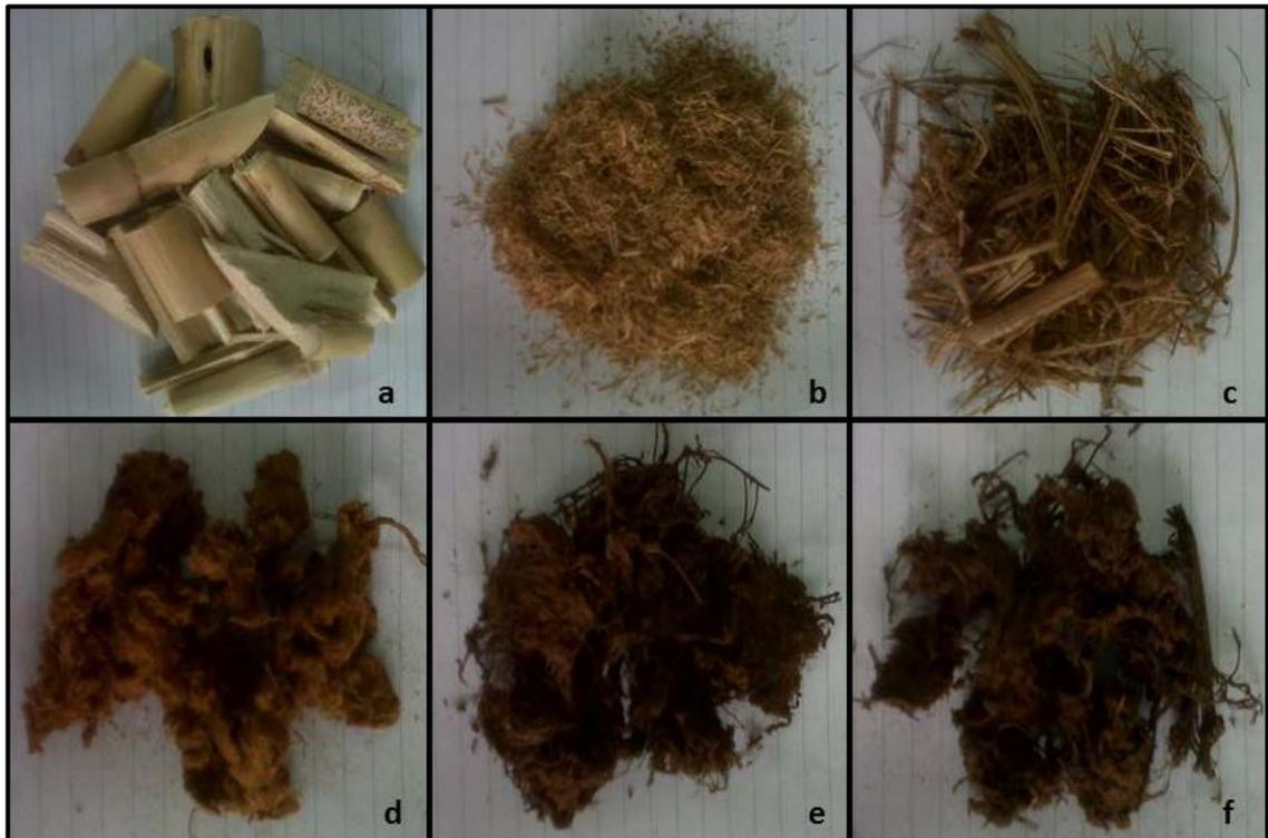
**Figura 10.** Efecto del pretratamiento *steam explosion* a diferentes severidades. a) Caña flecha. b) caña flecha SE 3.15. c) caña flecha SE 3.4. d) caña flecha SE 4. e) caña flecha SE 4.6. f) caña flecha SE 4.8.
