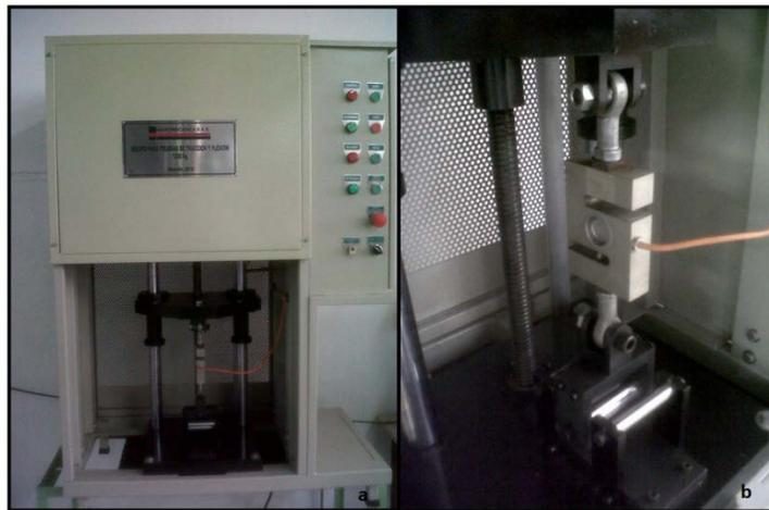
**Figura 8.** a) Máquina Universal de Ensayos. b) Mecanismo para determinación de propiedades mecánicas.
