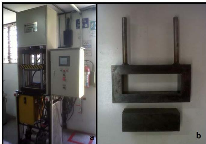
**Figura 7.** a) Prensa Hidráulica de 30 Toneladas con temporizador. b) Caja de formación de tableros.
