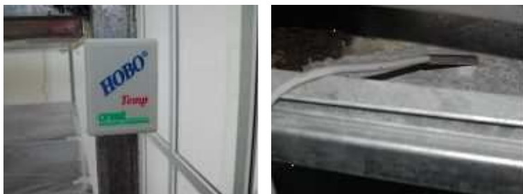
Εικόνα 6. Καταγραφή της θερμοκρασίας. Αριστερά: συσκευή καταγραφής δεδομένων θερμοκρασίας. Δεξιά: αισθητήρας μέτρησης θερμοκρασίας
