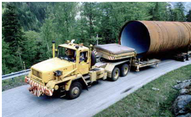
Obr. 9-29 Doprava dílu ocelového potrubí délky 18 m a hmotnosti 45 t k horní nádrži PVE v roce 1992 (soukromý archiv Jana Hölla).
