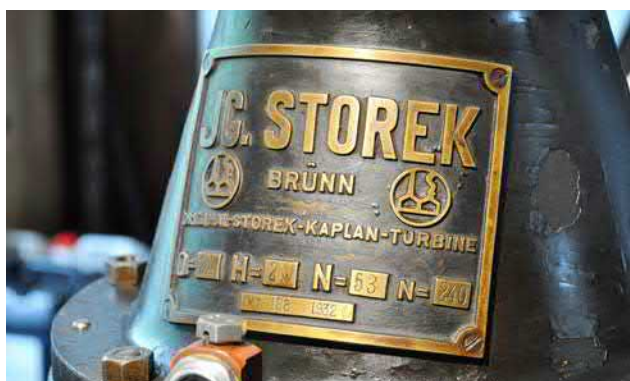
Obr. 8-6 Výrobní štítek obnovené turbíny malé vodní elektrárny v bývalém mlýně ve Starých Těchanovicích (foto Miriam Dzuráková, 2019).
