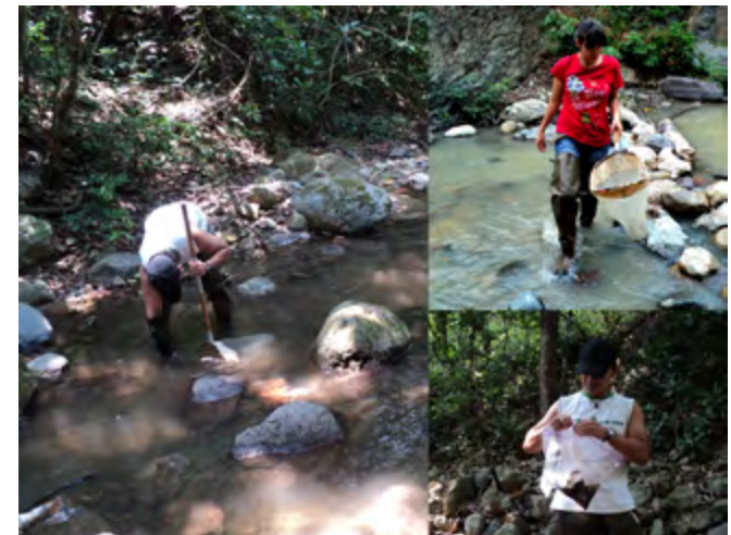
Fig.1 Proceso de muestreo con la Red “D”.
