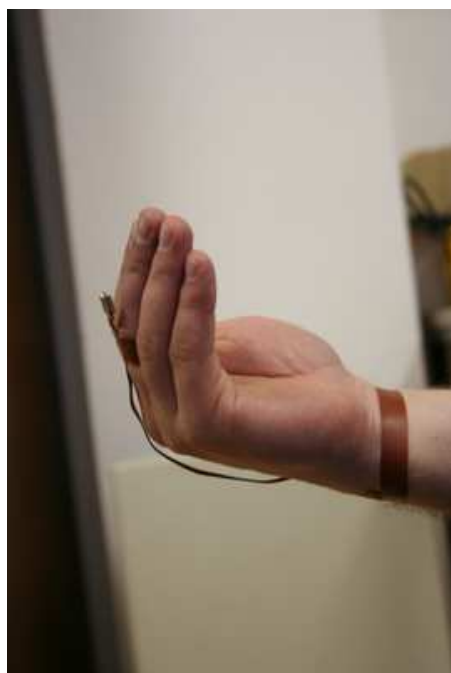
Foto č.2: Detail umístění akcelerometru
