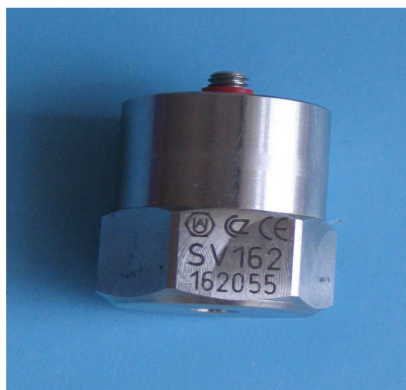
Obrázek č. 2: Piezoelektrický snímač SV162
