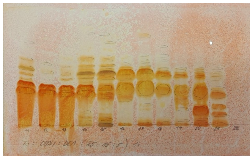
Obrázek 36: Chromatogram spojených frakcí 11-21 (S16, vyvinuto 1x, detekce Dragendorffovým činidlem)
