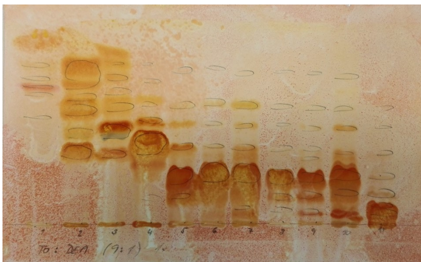
Obrázek 35: Chromatogram spojených frakcí 1-11 (S13, vyvinuto 1x, detekce Dragendorffovým činidlem)
