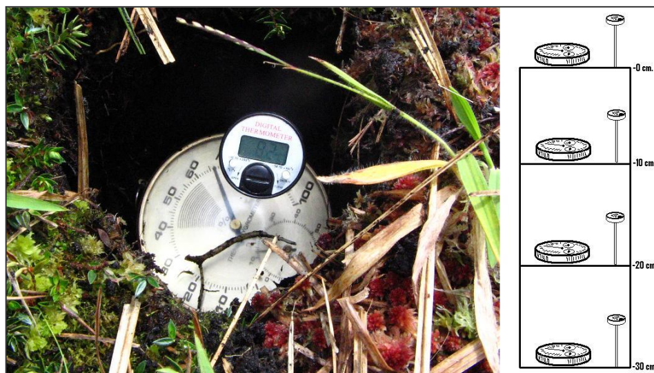
Foto 2.37 Método para registrar la humedad relativa y la temperatura del suelo en los diferentes humedales (Fotografía: Corporación Semillas de Agua, 2006).
