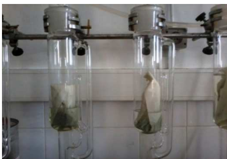
Imagem 3: Cartuchos de papel de filtro dentro do tubo extrator do equipamento de Soxhlet .
