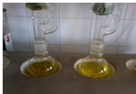
Imagem 4: Balões de fundo redondo com éter de petróleo na base de ebulição (40°C) do equipamento de Soxhlet .
