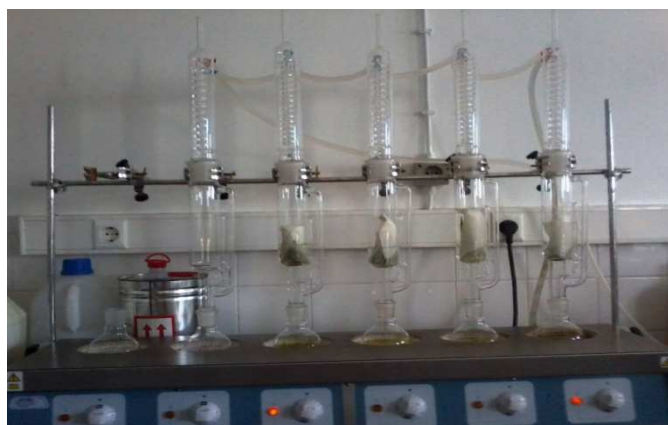
Imagem 5: Equipamento de Soxhlet completo, constituído por: balões de fundo redondo sobre a manta de aquecimento; tubos extratores com os cartuchos acoplados a condensadores.
