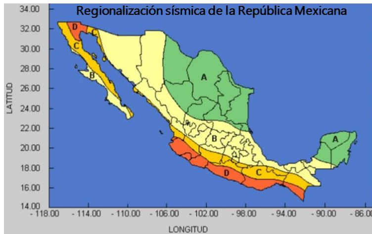
Zonas sísmicas de México. Imagen tomada del Manual de diseño de Obras Civiles (Diseño por Sismo) de la Comisión Federal de Electricidad citado en el Sistema Sismológico Nacional, 2016.
