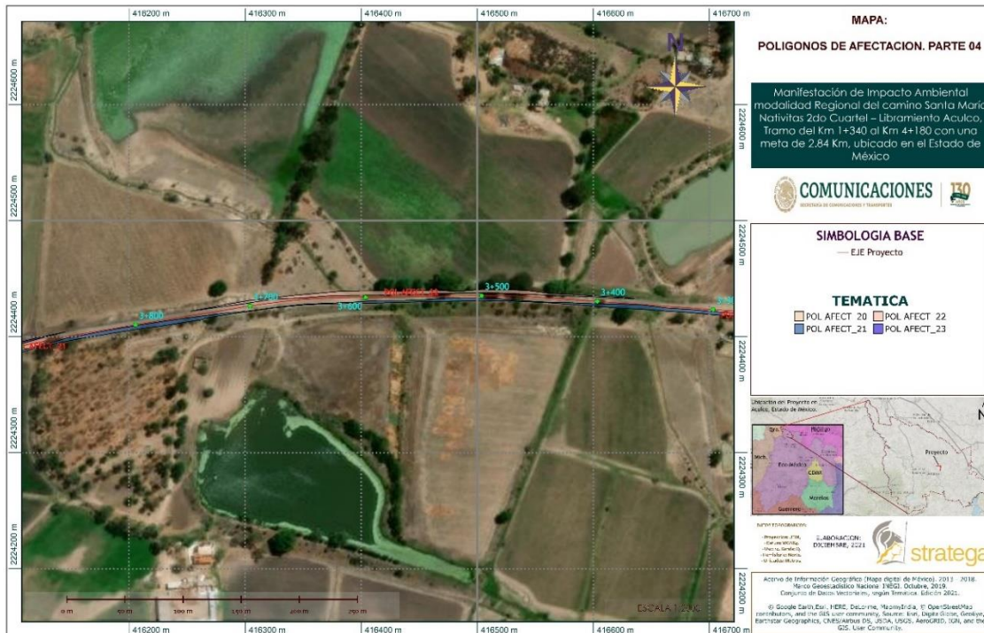
Figura 43. Polígonos de afectación, parte 04.
