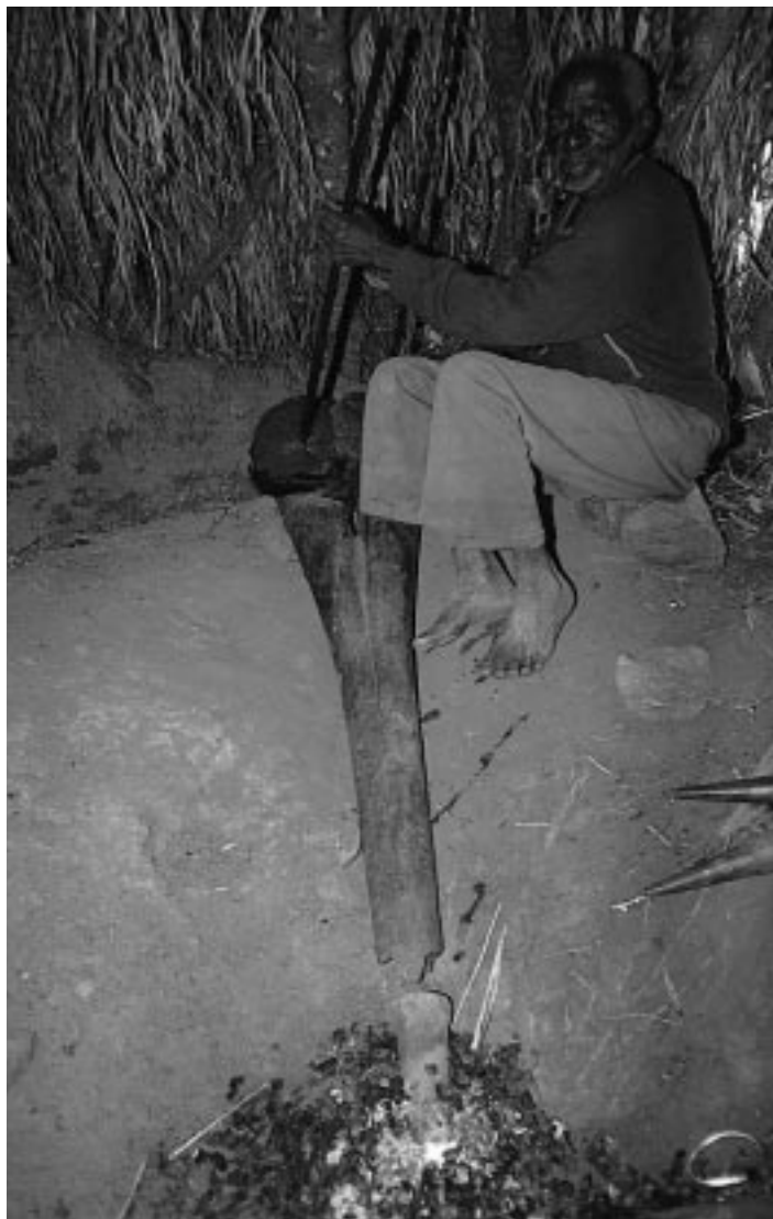
Photo 16. La technologie de fonte du fer introduite sur les hautes terres de Rukiga il y a environ 2000 ans est encore utilisée de nos jours sans grands changements par les forgerons ( omuhesi ) de la région. Soufflets de forge ( omuzuba ) en bois de Polyscias fulva ( omungo ) et tuyères d'argile ( encheru ).
