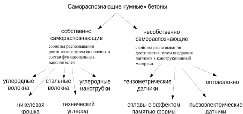
Рисунок 1 – Краткая классификация самораспознающих бетонов.
