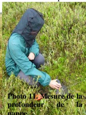
Photo 11. Mesure de la profondeur de la nappe.
