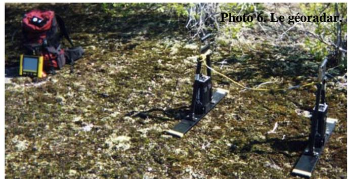
Les deux antennes sont reliées à une console, elle-même reliée à un ordinateur portable, permettant ainsi de visualiser les données recueillies pendant leur acquisition sur le terrain et de configurer la console. L'énergie nécessaire est fournie par deux batteries (du type de celles utilisées pour les automobiles). Afin de limiter les interférences électromagnétiques, les connexions entre les différents composants du GPR sont en fibres optiques (Bano, 2000).
