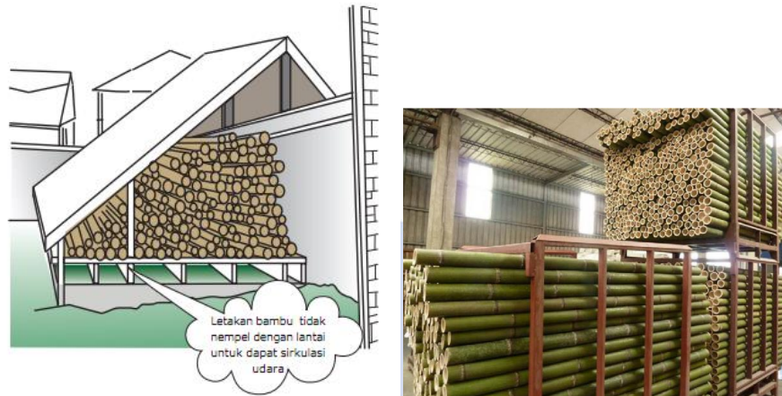
Gambar II. 11 Ilustrasi Cara Penyimpanan Bambu Awet dalam Sistem VSD Sumber : Linda Garland, 2003
