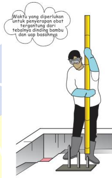
Gambar II. 10 . Ilustrasi Pemecahan Buku Bambu dalam Sistem VSD
