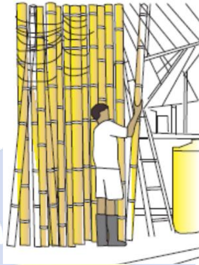
Gambar II. 9 Ilustrasi Peletakan Bambu dalam Sistem VSD
