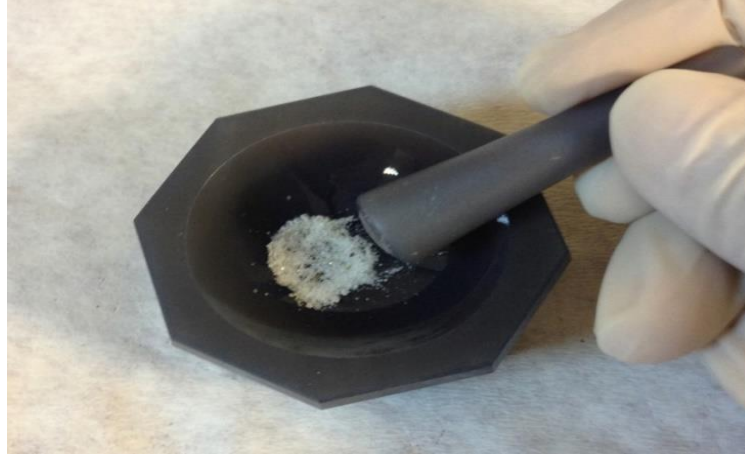
Şekil 2.2. FT-IR spektroskopisi için toz haline getirilen bitki katı örneklerin havan içinde potasyum bromür (KBr) ile karıştırılması
