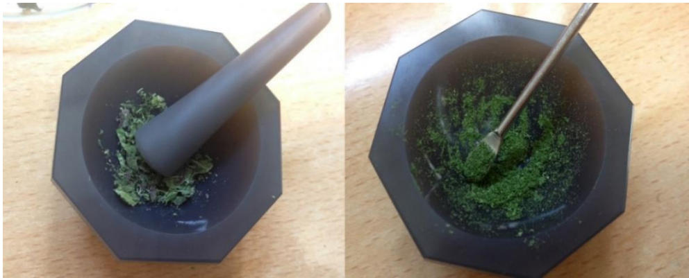
Şekil 2.1. FT-IR spektroskopisi için kurutulmuş bitki katı örneklerin hazırlanması sırasında havan içinde toz haline getirilmesi
