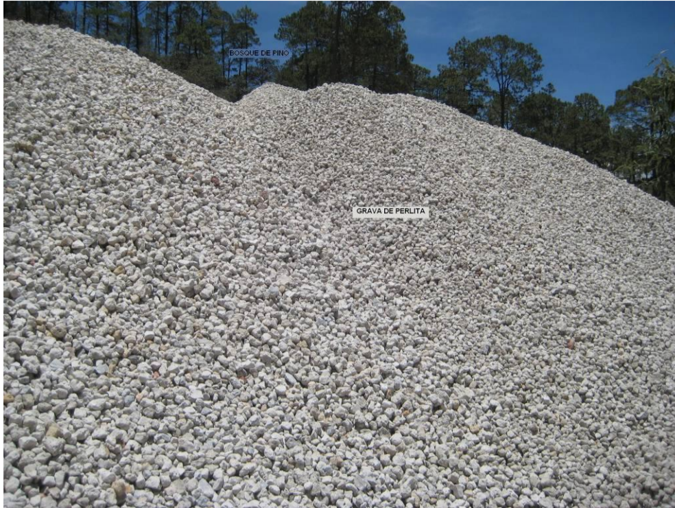
Fotografía 21. Roca vidrio perlita asociada a erupciones volcánicas de rocas ácidas, utilizada para aligeramiento de lozas, en la industria de la construcción.
