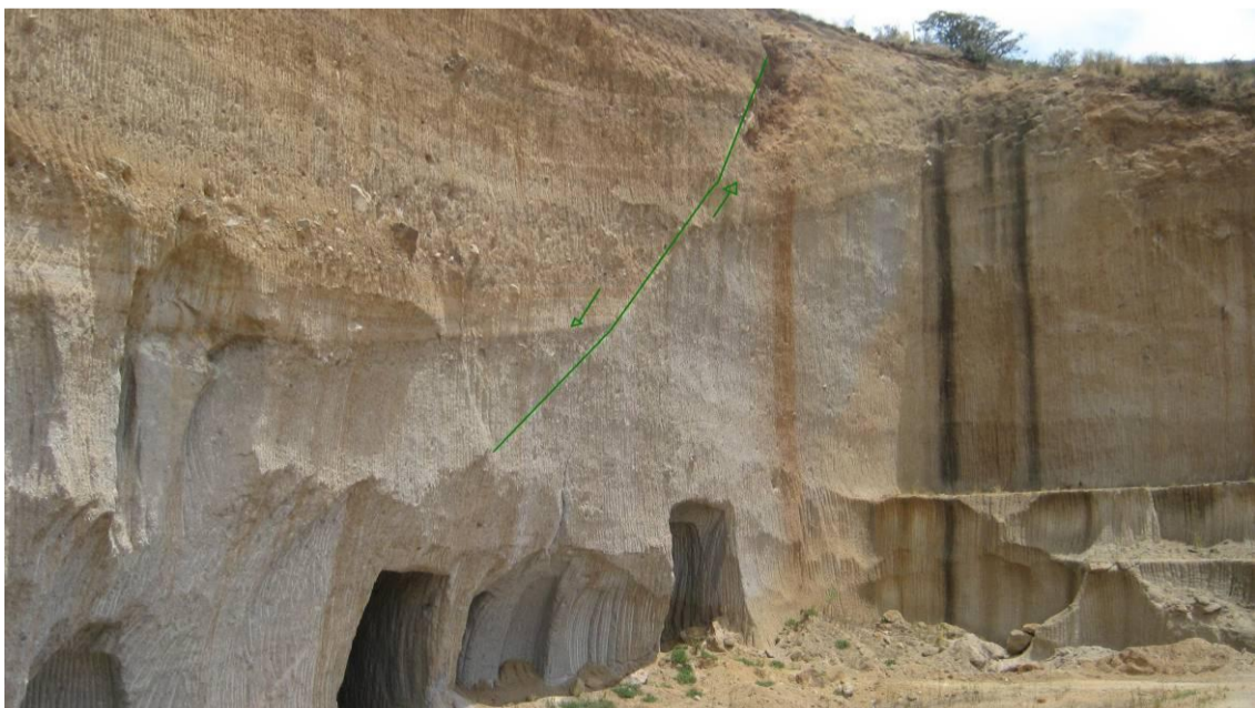
Fotografía 34. Socavones de minas de Perlita, cercanos a la ciudad de Tulancingo, como parte de un domo Riolítica, se observa en verde una falla normal con la caída al lado izquierdo en las rocas piroclasticas.
