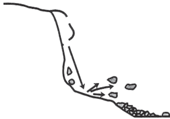
Figura 30. Caídos o derrumbes, CENAPRED 2001
