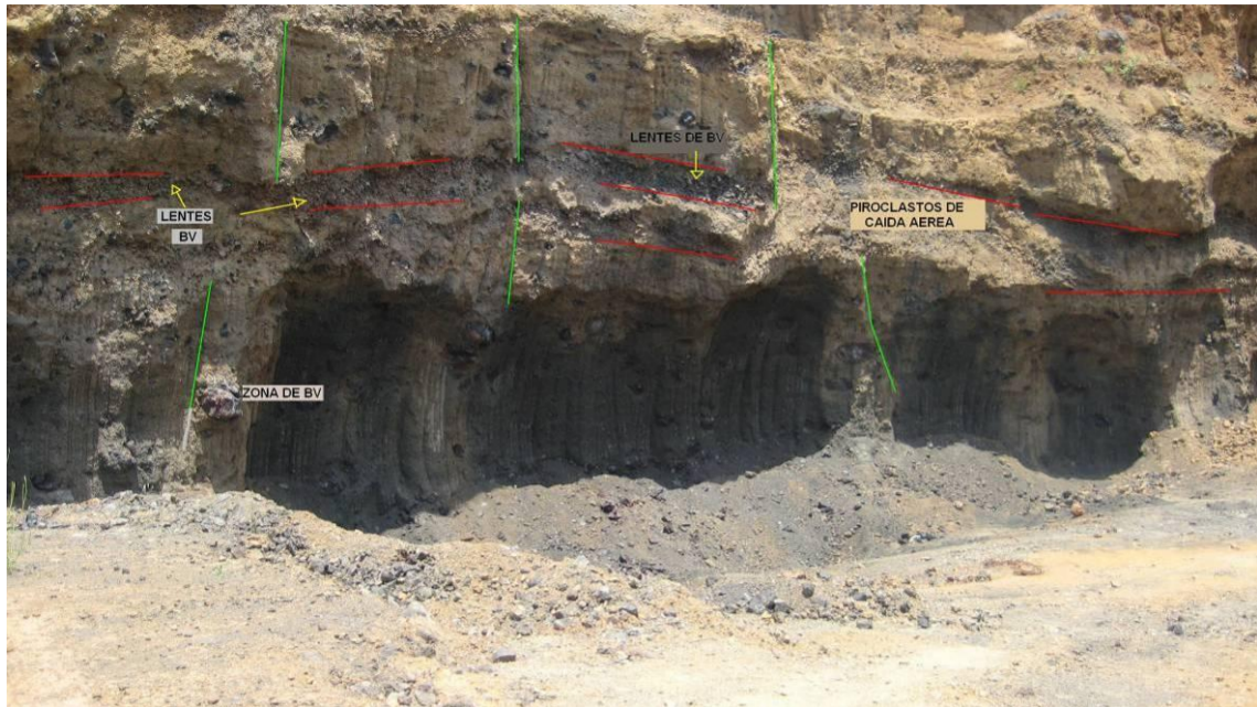
Fotografía 36. Cerca de Lago de Tecocomulco, se tienen rocas piroclásticas con lentes de Brecha Volcánica, de color gris oscuro en forma de grava y arena, con fracturamiento que aumenta la porosidad de la roca.
